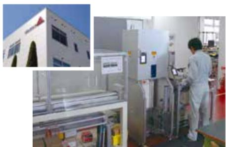
マイナス19.6℃から200.0℃近くまでの領域を測定できる同社の温度センサーは、海外で製造した素材を国内で組み立て(アッセンブリ)し、一貫生産を行うなど、独自の自動化製造ラインによる安定した品質と低コストを実現。製鉄から電力、石油化学、環境設備や医療業界といったさまざまな業界で国際的に活躍しており、国内シェアは30%を有しています。
