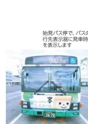
始発バス停で、バスの行先表示器に発車時刻を表示します
