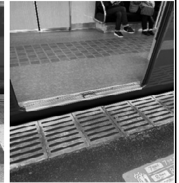
ホームとの隙間
