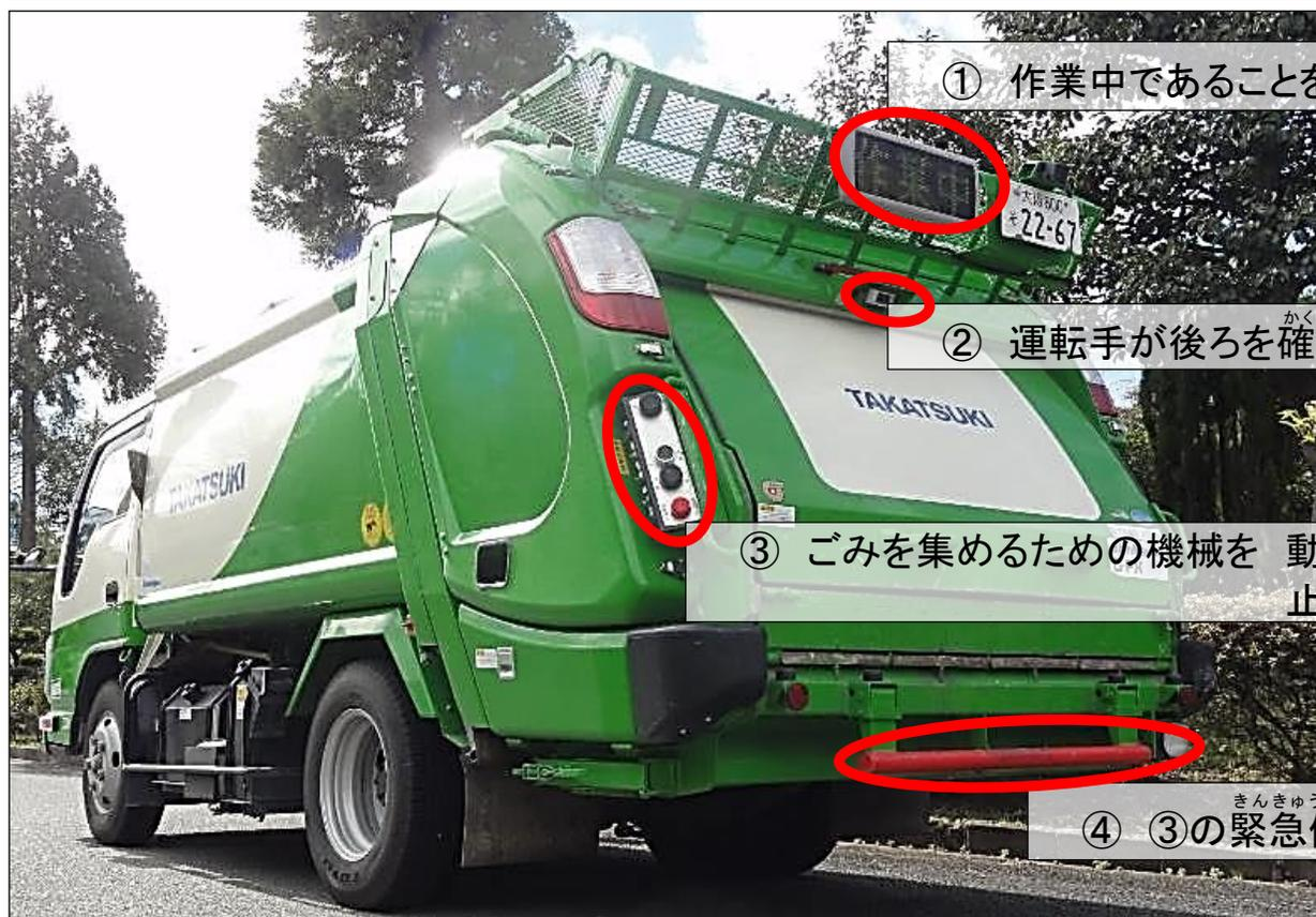
① 作業中であることを知らせるための電光掲示板
