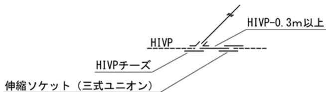
図-2.3.1.4 HIVE から HIVE をチーズ分岐する施工例
